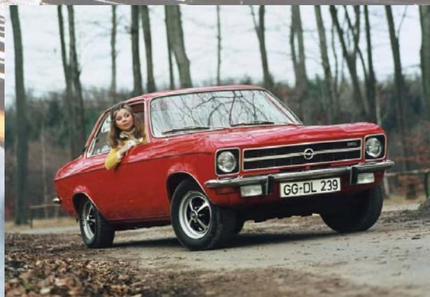
Mit einer zweitürigen Limousine gehen Walter Röhl und Jochen Berger 1974 in der Rallye-Europameisterschaft an den Start. Der Ascona des Opel-Euro-Händler-Teams hat einen Vierzylinder-Motor, der durch Aufbohren auf 2 Liter Hubraum und mit einem Aluminium-Querstrom-Zylinderkopf über 200 PS bei 6700 U/min abgibt. Röhl und Berger siegen bei sechs von acht Läufen und gewinnen die Rallye-EM mit der bis dahin unerreichten Maximal-Punktzahl von 120 Zählern.
