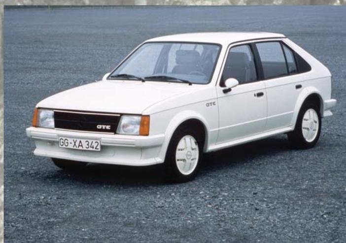
1981 wird die Motorenpalette um einen 90 PS leistenden 1,6 Liter-Vierzylinder ergänzt. 1982 bietet Opel mit dem 54 PS starken 1,6 D zum ersten Mal einen Dieselmotor in der Kompaktklasse an. Das sportliche Topmodell debütiert im Januar 1983: der Kadett GTE verfügt über einen 1,8 Liter-Motor mit 115 PS und ist 187 km/h schnell. Bis zum Generationswechsel im Spätsommer 1984 produziert Opel rund 2,1 Millionen Einheiten des Kadett D.
